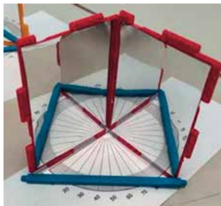
Slike 7–10: Konstruiranje pravilnega večkotnika s pomočjo dveh zrcal.
