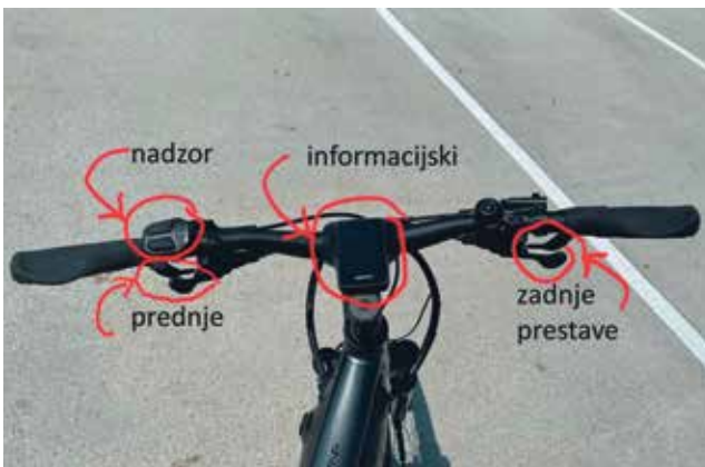
Slika 3: Pomembne nadzorne in krmilne komponente električnega kolesa.
