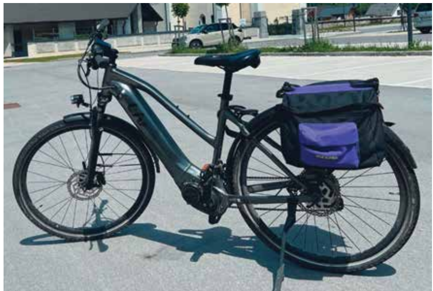
Slika 2: Baterija se skriva v odebeljenem nosilnem okvirju, elektromotor pa neposredno v bližini osi pedalov.
