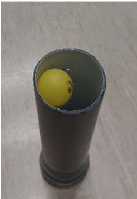
Slika 1: Vodni top, ki je sestavljen iz žogice v posodi z vodo.
