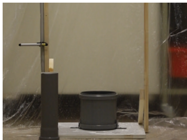
Slika 6: Eksperimentalna ploščad z leseno osnovno ploščo, lesene palice z merilno skalo in premični laser za lažje odčitavanje višine.
