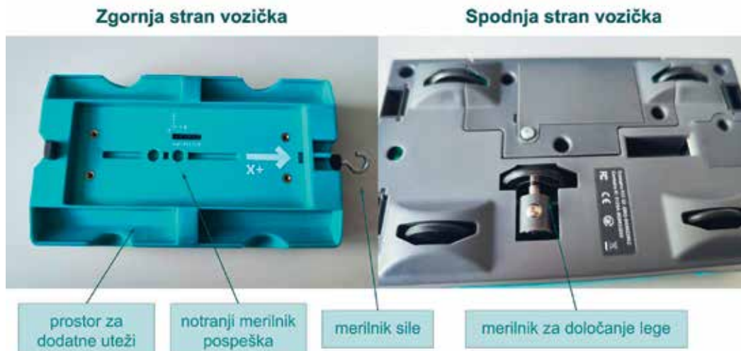
Slika 3: Opis vozička. Prikazana sta zgornji in spodnji del vozička Go Direct Sensor Cart.
