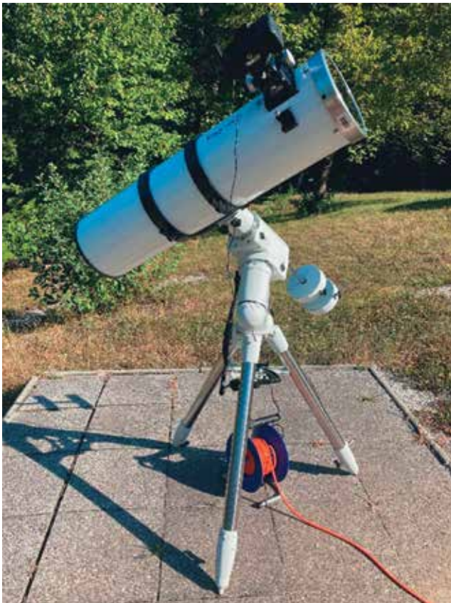
Slika 6: 20-centimetrski Newtonov teleskop s steklenim filtrom Thousand Oaks in digitalnim fotoaparatom Canon EOS 700D. Vir: osebni arhiv.
