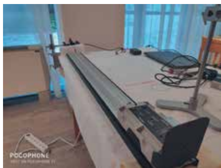
Slika 10: Otok 4 – preizkušanje opreme, ki jo je prinesla ena od udeleženk: voziček, svetlobna vrata in škripec, ki prekinja svetlobni curek.
