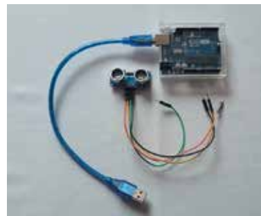
Slika 18: Krmilnik in senzor za merjenje oddaljenosti s pomočjo ultrazvoka.
