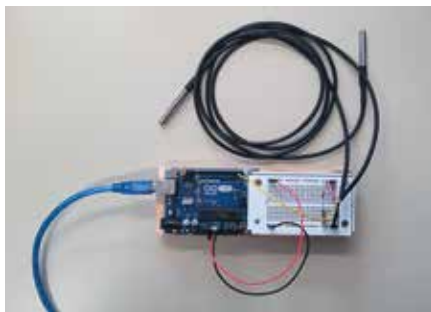
Slika 16: Priklop dveh vodoodpornih termometrov na krmilnik.
