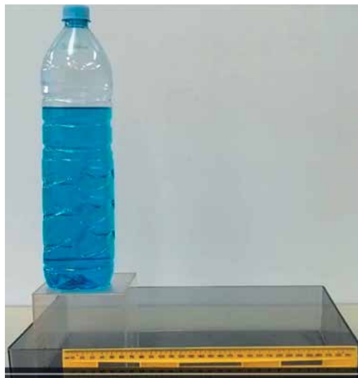
Slika 1: Postavitev poskusa. Plastenka stoji na podstavku, da je curek bolje viden in lažje spremljamo, kako se spreminjajo njegove lastnosti.
