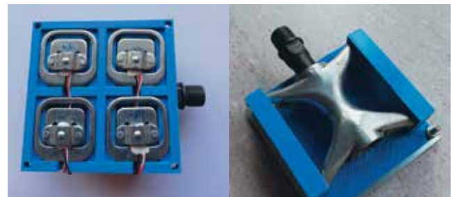
Slika 7: Spodnji del platforme brez merilnikov (desno) in zgornji del platforme s štirimi dualnimi uporovnimi lističi (strain gauge) vezanimi v mostič (levo).
