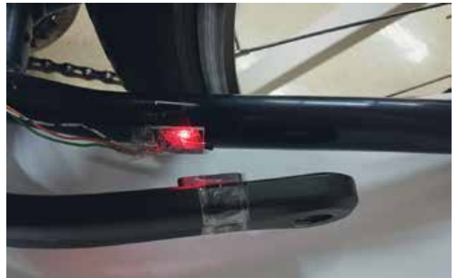
Slika 10: Merjenje frekvence pedaliranja. Pritrditev trajnega magneta na gonilko in Hallovega senzorca na okvir.
