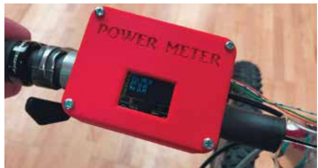
Slika 11: Prikazovalnik sile, kadenca in povprečne moči na krmilu.
