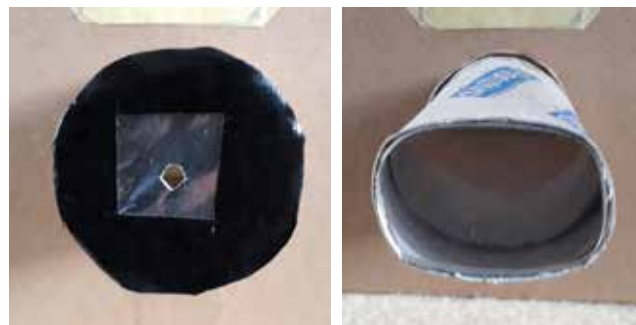
Sliki 7ab: Objektiv z luknjico (a) in objektiv z lečo (b), ki je sestavljena iz dveh leč očal.
