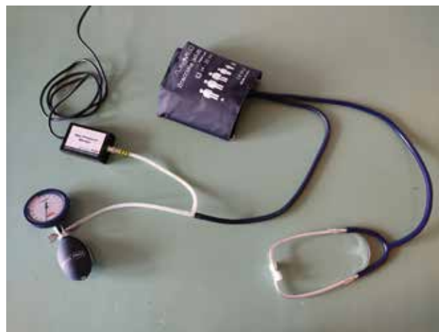
Slika 5: Mehanski merilnik krvnega tlaka, prirejen za zajem časovne odvisnosti tlaka v manšeti z računalnikom.
