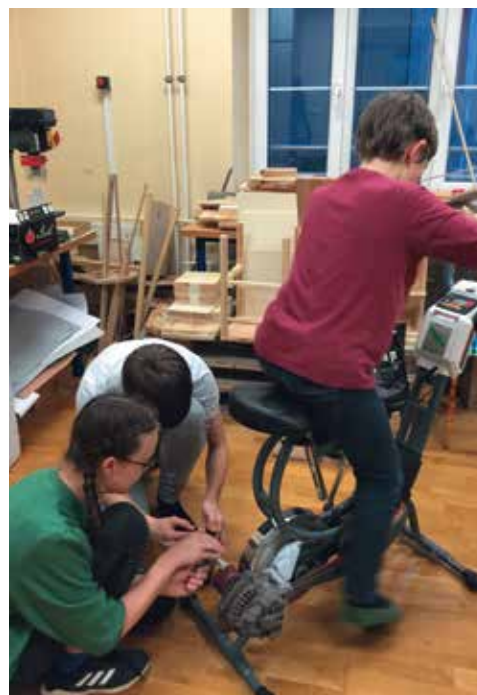
Slika 3: Sobno kolo, prirejeno za polnjenje mobilnih naprav
