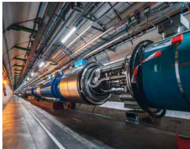
Slika 5: Veliki hadronski trkalnik v CERN. Na sliki so tunel, ki leži sto metrov pod zemljo, in veliki superprevodni magneti, ki usmerjajo žarke protonov. [21]
