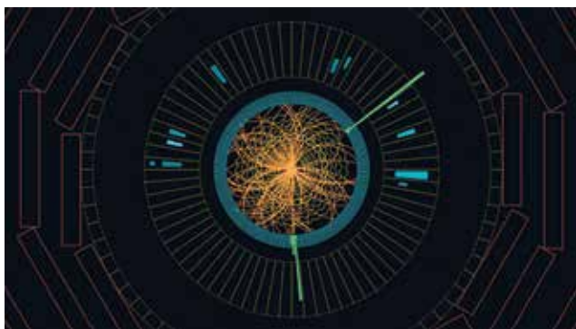
Slika 6: Vizualizacija trka dveh protonov v detektorju CMS, pri katerem nastaneta dva visokoenergijska fotona, prikazana z zeleno barvo. Slika bi lahko prikazovala delce, ki so nastali po transformaciji Higsovega bozona, vendar tega ne moremo vedeti brez statistične analize. [22]
