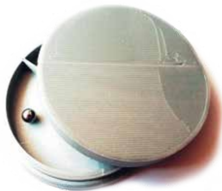
Slika 2: Škatla skrivnosti s skrito notranjo strukturo in jekleno kroglico. Škatla je natisnjena s 3D-tiskalnikom. Navodila za to 3D-natisnjeno škatlo lahko najdete na https://scoollab.web.cern.ch/3d-printable-mystery-box . [18]
