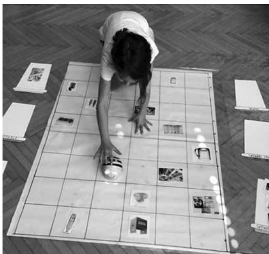
Slika 2: Beebota učenci programirajo s pritiskanjem na gumb, ki so na vrhu (levo, desno, naprej, nazaj, premor, stop, izbriši). Učenka se uči programiranja po korakih, tako da z beebotom pobira smeti po mreži ter jih ločuje v smetnjake.
