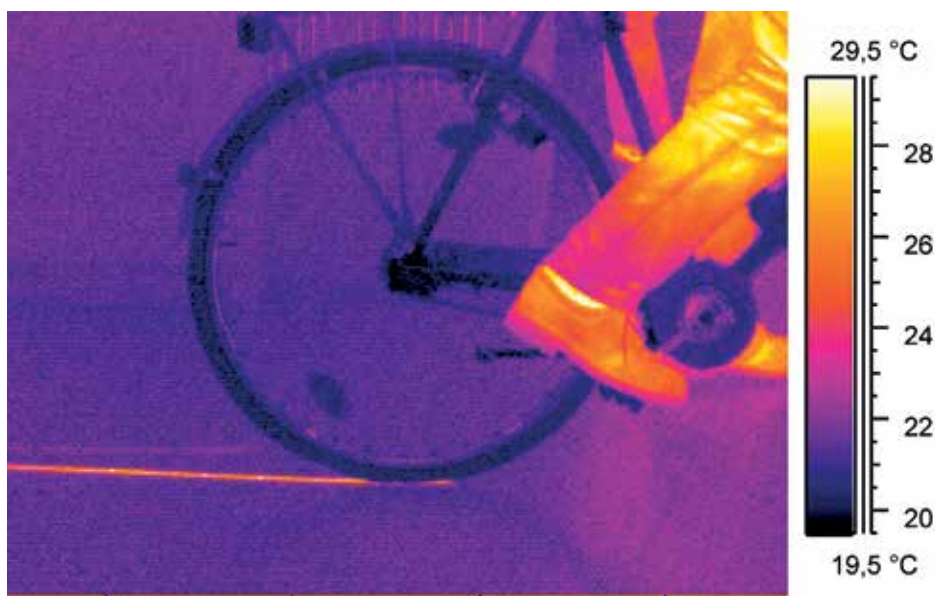
Slika 3: Infrardeča kamera kaže kolo in njegovo okolico po zaviranju z zablokiranim kolesom, ki je drselo po podlagi. Sled zaviranja je vidna kot podlaga z višjo temperaturo, temperatura obroča kolesa pa se ni zvišala. Sliko je prijazno prispeval avtor članka [4] Michael Vollmer.
