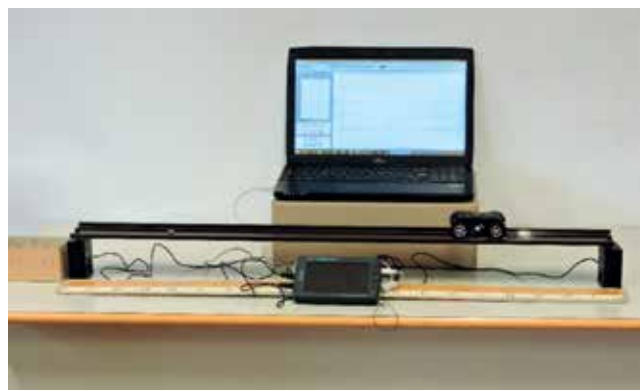
Slika 5: Postavitev eksperimenta pri izvedbi meritev za vodoraven most.
