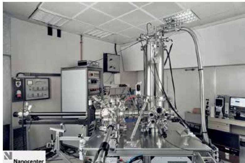
Slika 2: Nizkotemperaturni vrstični tunelski mikroskop na Inštitutu Jožef Stefan.
