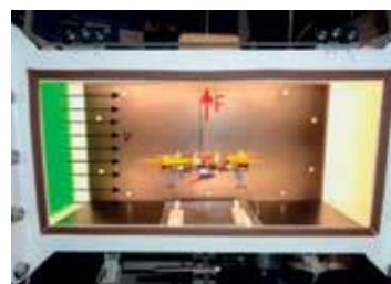
Slika 19: Vpliv vodoravnega toka v merilni komori.
