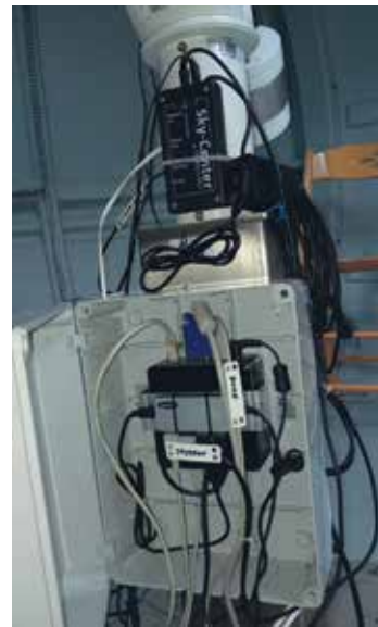
Slika 4: Nadzorni mini računalnik teleskopa je Intel NUC, ki deluje v operacijskem sistemu Windows 10. Računalnik ima 4 GB pomnilnika in 120 GB SSD-disk, deluje kot strežnik VNC za oddaljeno namizje. Na računalnik smo priključili vse naprave in senzorje, ki jih potrebujemo v opazovalni kupoli za daljinsko upravljanje.
