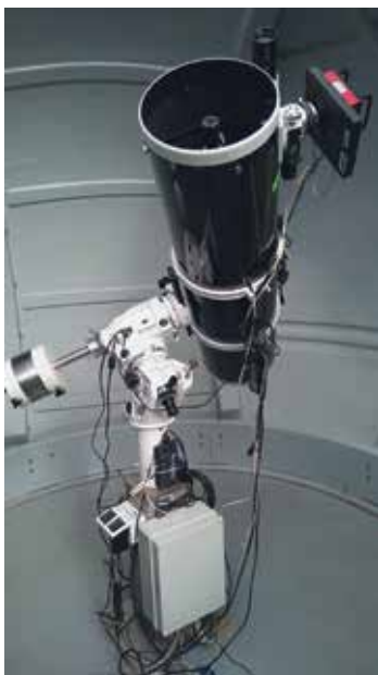
Slika 3: Teleskop SkyWatcher na ekvatorialnem stojalu, opremljen z astronomsko CCD-kamero, optičnimi filtri R, G, B, L in H-alfa ter teleskopom za natančno sledenje.
