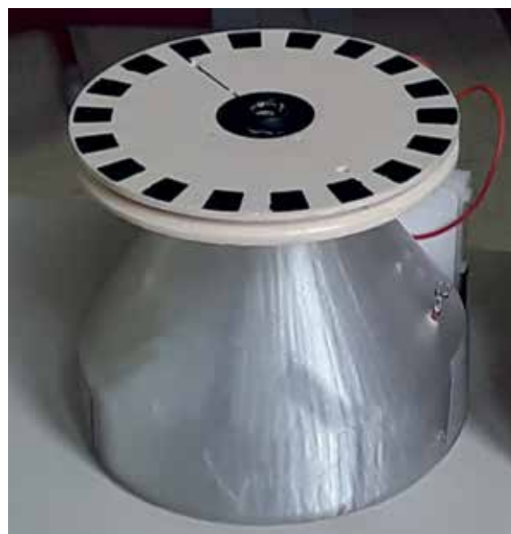
Slika 3: Razvojne faze ohišja z motorjem in vztrajnikom.
