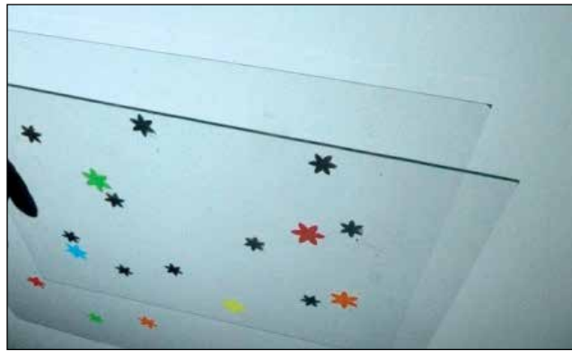
Slika 7: Steklena plošča z nalepkami rožic na razdalji 10 cm od zaslona – okroglo svetilo.
