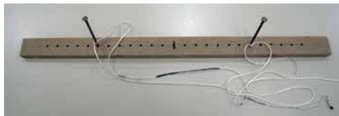
Slika 14: Mehanski pripomoček za vrtnarsko konstrukcijo elipse.
