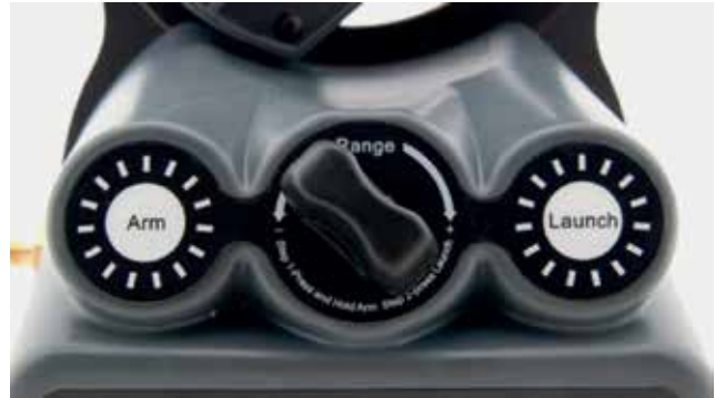
Slika 5: Gumba za izstrelitev (Arm in Launch) in vrtljivi gumb (Range) za nastavljanje hitrosti, vir slike [2].
