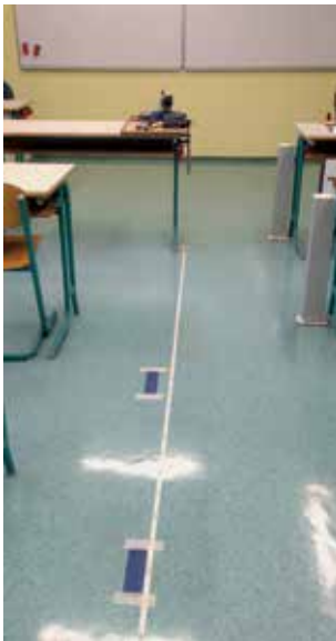
Slika 6: Postavitev pri meritvah dometa pri vodoravnem metu.
