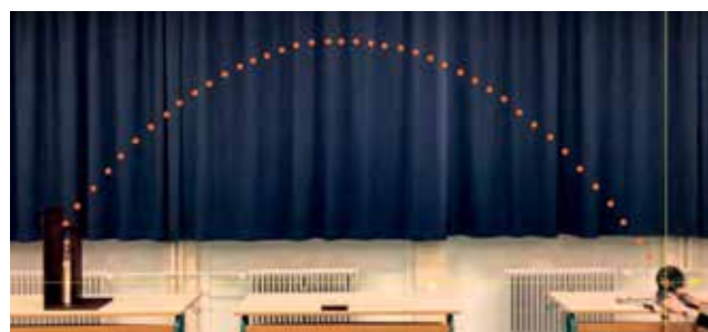
Slika 17: Tir kroglice pri zadetku koša na razdalji 3,6 m, višina 36,4 cm, hitrost 6,4 m/s, kot 56°. Dolžina mize je 1,2 m za lažjo oceno razdalje. Videoposnetek z 240 slikami na sekundo je bil obdelan v programu LoggerPro. Točke si sledijo v časovnih razmikih 1/40 sekunde.
