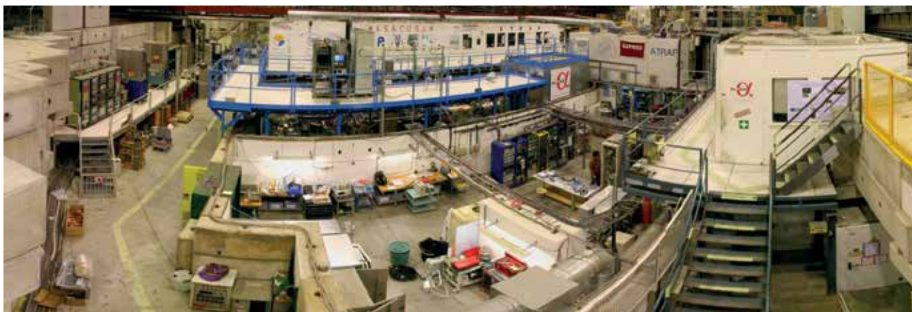
Slika 1: Položaj antiprotonskega deceleratorja v CERN-u. Gruče protonov najprej pospeši linearni pospeševalnik, nato jih vbrizgajo v krožni pospeševalnik in iz njega v protonski sinhrotron, ki jih pospeši do energije 26 GeV. Te vbrizgajo v veliki hadronski trkalnik ali jih usmerijo na tarčo, v kateri nastanejo antiprotini. Del teh zajame antiprotonski decelerator.
