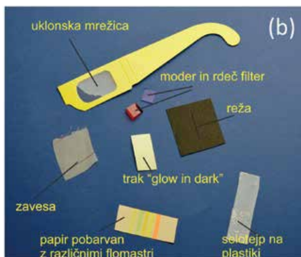
Slika 3: a) senzorji fizikalnih količin v telefonih omogočajo izvedbo različnih kvantitativnih domačih poskusov; b) preprosta oprema, ki smo jo študentom poslali v kuverti po pošti.
