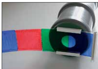
Slika 13: Nastavek z barvnimi filtri.
