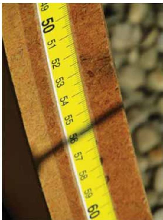
Slika 2: Primer odčitka višine sonca na sončnem višinomeru. Odčitavanje je bilo narejeno v dopoldanskem času junija, saj odčitek prikazuje, da je bilo sonce visoko 56 stopinj.
