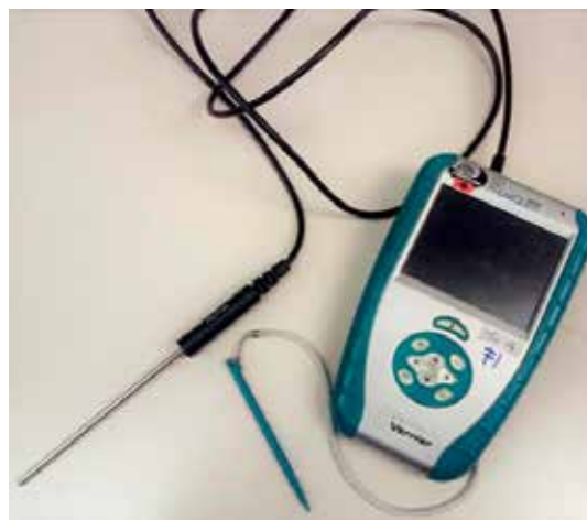
Slika 3: Vernierjeva naprava LabQuest za izvajanje meritev, z vmesnikom za merjenje temperature
