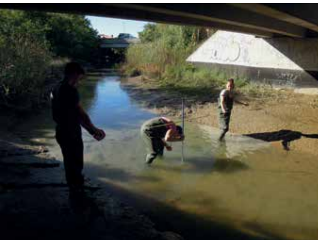
Slika 2: Za meritve uporabimo 20-metrski merilni trak in 1,4-metrsko merilno letev.
