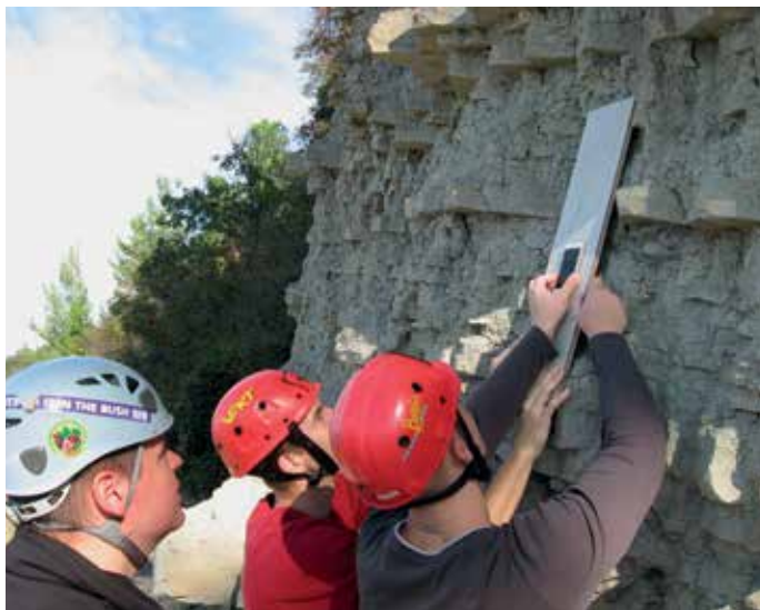
Slika 6: Določitev nagiba klifne stene
