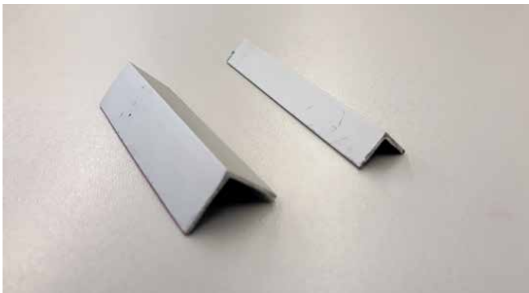
Slika 7: Aluminijast L-profil uporabim za izdelavo jahača.
