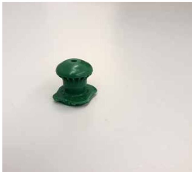
Slika 6: Zamašek z vibracijsko žago prilagodimo tako, da se prilega notranjosti aluminijastega profila.
