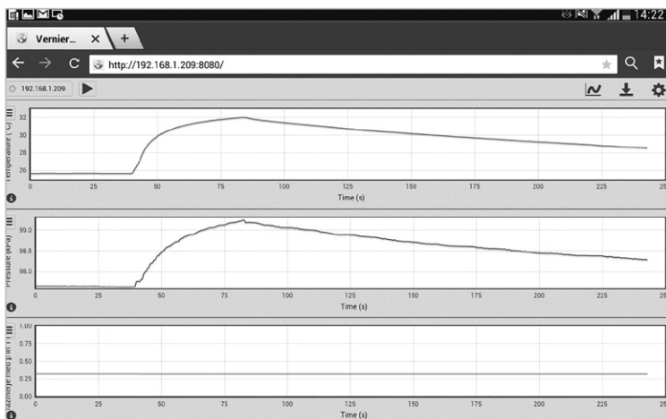
Sliki 7 in 8: Rezultati demonstracijske računalniško podprte meritve spreminjanja tlaka in temperature pri izohorni spremembi stanja plina, kot jih prejmejo dijaki med izvajanjem meritev na svoje mobilne naprave.
