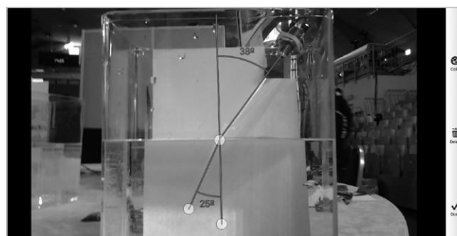
Slika 3: Merjenje vpadnega in lomnega kota na fotografiji z aplikacijo na tabličnem računalniku
