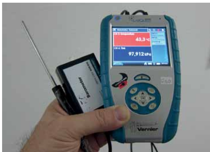
Slika 1: Vmesnik s priključenima tipaloma za temperaturo in tlak. Na zaslonu vmesnika je zapis obeh vrednosti.
