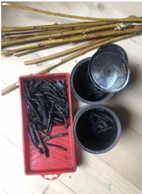
Suha destilacija vrbovega in lipovega lesa
