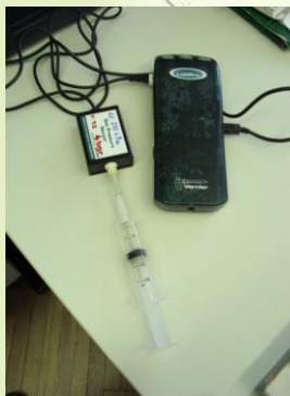
Slika 2: povezava brizge in senzorja
