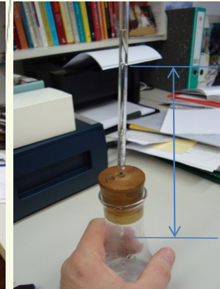
Slika 3, 4: Delovanje termometra. Puščica na desni sliki kaže višino h za katero se je dvignila kapljica, ko smo povečali temperaturo.
