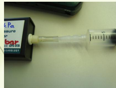
Slika 2: povezava brizge in senzorja
