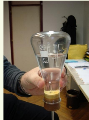
Slika 3, 4: Delovanje termometra. Puščica na desni sliki kaže višino h za katero se je dvignila kapljica, ko smo povečali temperaturo.
