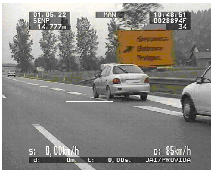
Policisti merijo varnostno razdaljo iz vozil, ki imajo vgrajen videonadzorni sistem Provida.
