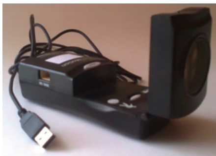
Slika 4: Ultrazvočni slednik Go!Motion, ki ga lahko z računalnikom povežemo neposredno prek USB (vir: lasten).
